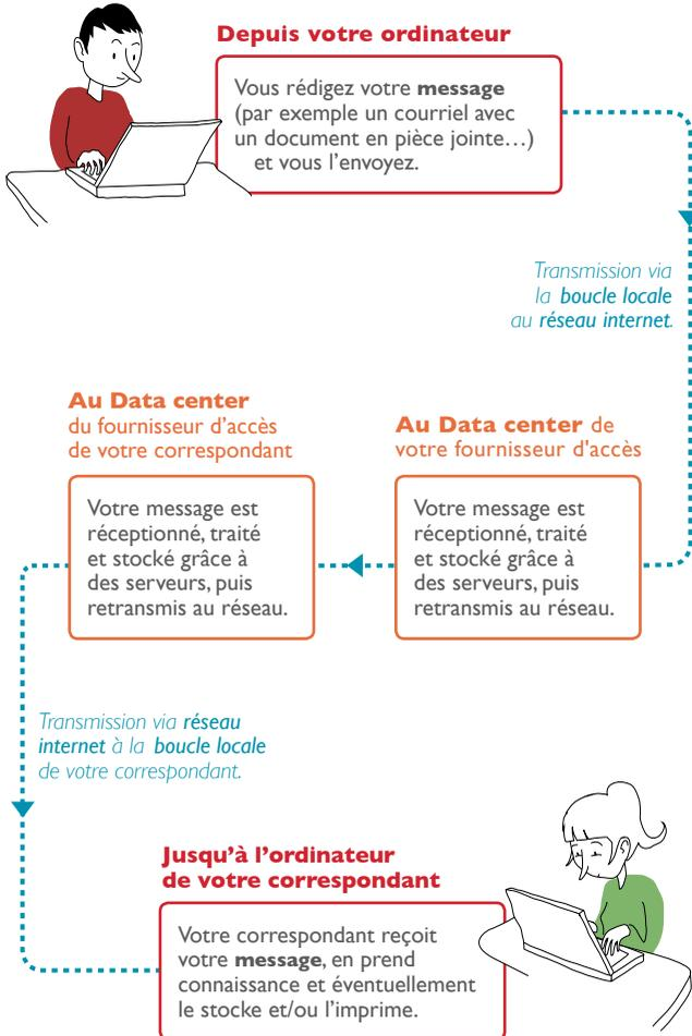
NB: ce schéma de principe ne détaille pas précisément toutes les étapes mises en œuvre.
